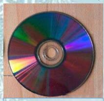
СD изготовлены из поликарбоната. Материал достаточно прочный и легкий, легко поддается обработке ручным инструментом
